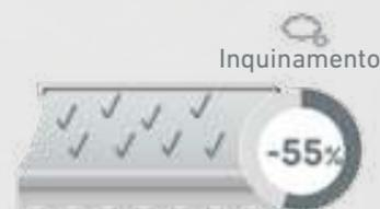
Questo processo viene ripetuto per pulire la superficie e l'aria, riducendo i livelli di biossido di azoto di circa il 55% nei test di laboratorio.
