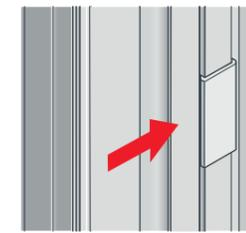
7.2 Lorsque la moustiquaire est fermée, l'ancrage est accroché sur la coulisse et la barre coulissante est fermement ramenée vers le profil de pli du tissu.
