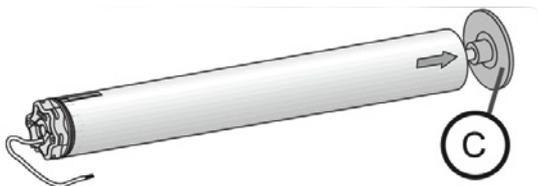
**4.1** Montar o conjunto tubo-motor no suporte da extremidade (C).
