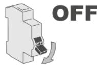
Cortar a corrente elétrica do toldo antes de realizar qualquer trabalho de manutenção no mesmo.
