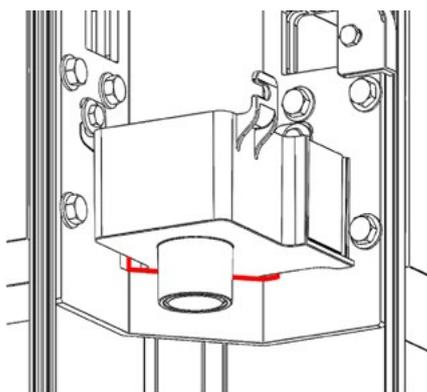
12. Por fim, colocar o tubo de drenagem nos tabuleiros coletores que o requeiram, de acordo com as descrições acima.
