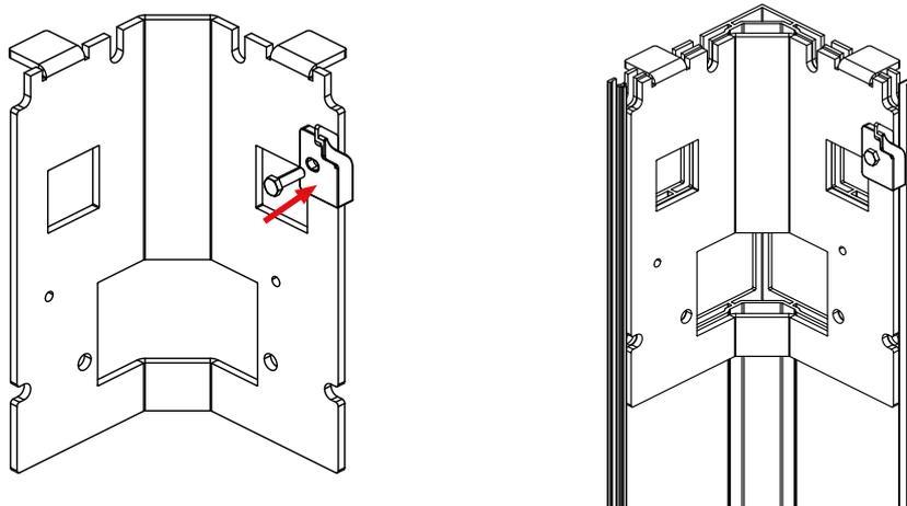
Verificar o nivelamento da viga de fecho em relação à base, a sua altura em relação ao plano e se todas as marcações em relação às fixações da base estão a 90°. A instalação correta da viga e das bases dos pilares são cruciais para o funcionamento ótimo da pérgula.
