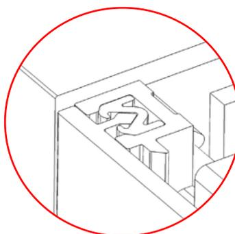
Desaparafusar ligeiramente o parafuso na parte superior da peça de acoplamento do perfil de cobertura à direita, para poder colocar o perfil no lugar. Depois, apertar novamente os parafusos até a coluna estar completamente fechada.
