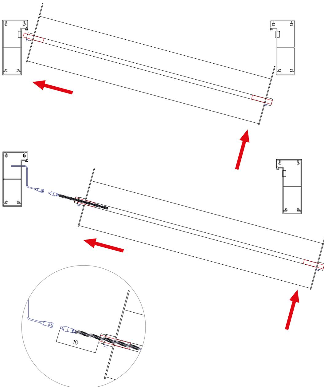
Instalar as lâminas inclinando-as com as abas dos tampas para baixo, introduzindo primeiro o eixo fixo (esquerda) e posteriormente o eixo móvel (direita).
