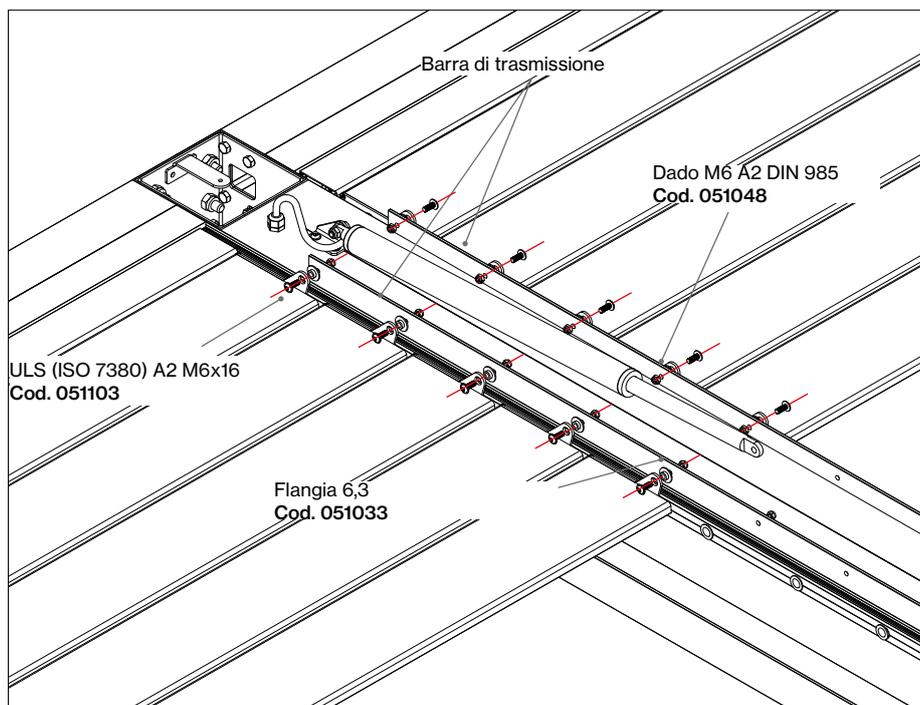
Per quanto riguarda le piattine delle travi **destra** e **sinistra**, queste possono essere installate anche dopo aver montato tutte le lamelle.
