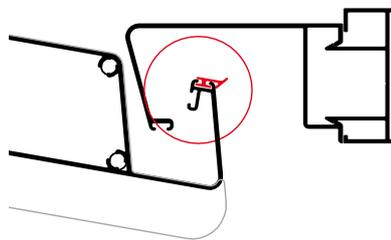
Posa della guarnizione sulle lamelle (Passaggio lama 150)
