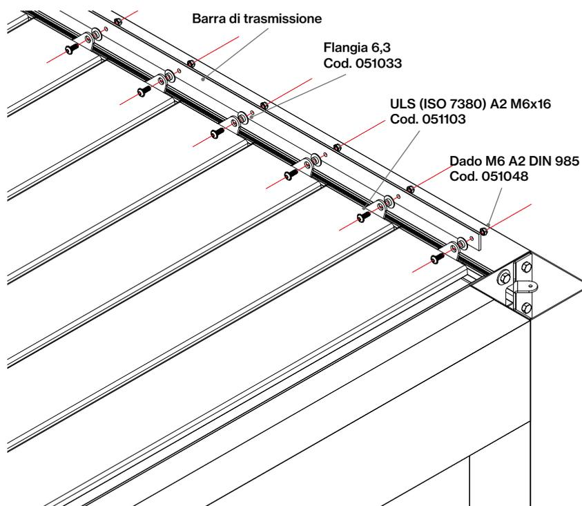
Unire le barre alle facciate con la corrispondente bulloneria ULS (ISO 7380) A2 M6x16, boccole di plastica con bordo da 6,3 mm e dado M6 DIN 985.
