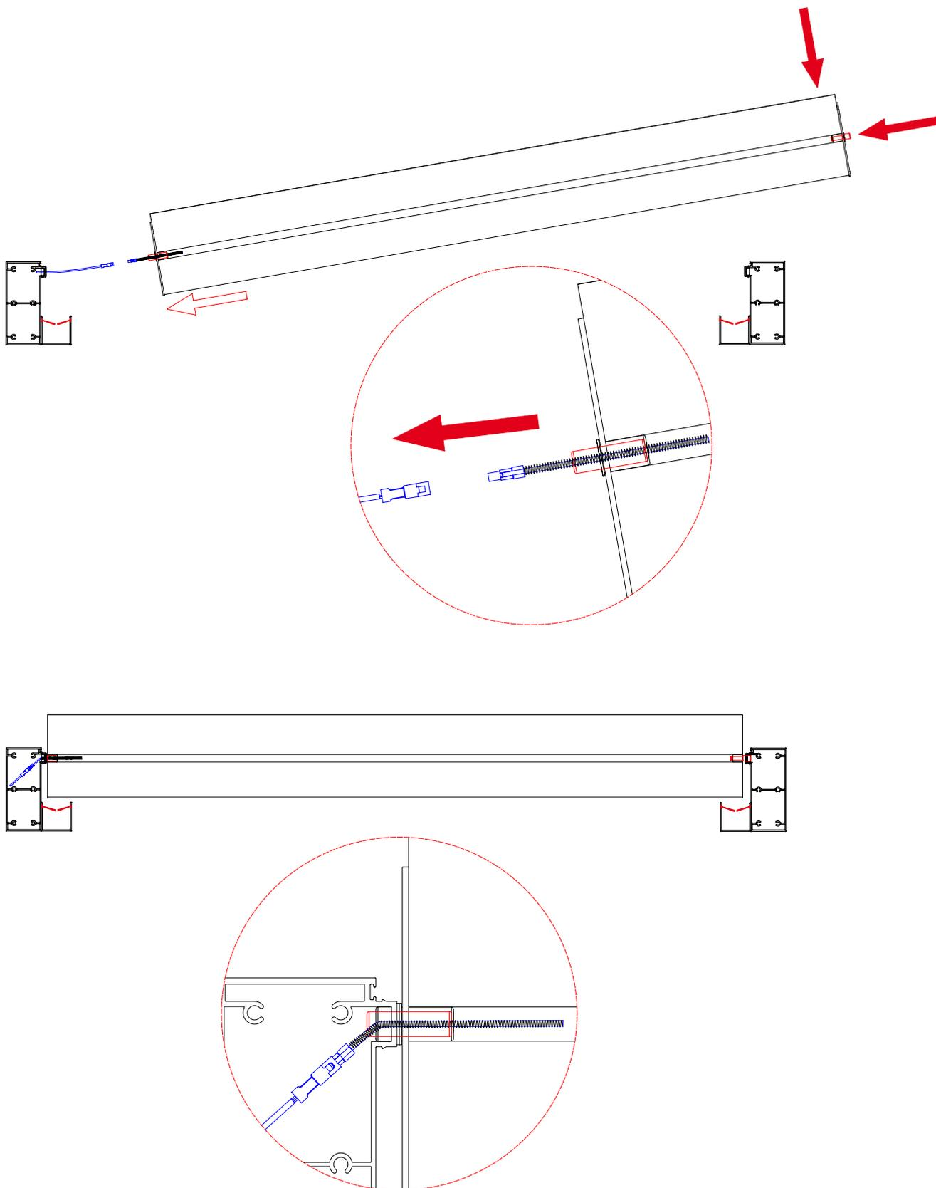
Durante l'installazione della V o VI lamella, per installare la **coppia tandem completa**, codice: 050307, è necessario raggiungere l'area in cui si trovano i fori meccanizzati sulle piattine di trasmissione.
