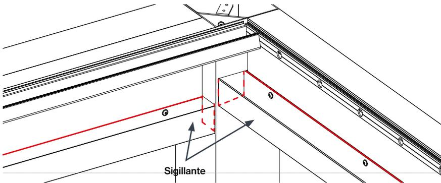
Per chiudere ermeticamente i canali a "U" alle travi e ai giunti da cui possono verificarsi perdite d'acqua, utilizzare il sigillante in dotazione.
