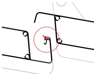
Posa della guarnizione sulle lamelle (Passaggio lama da 150 a 160)
