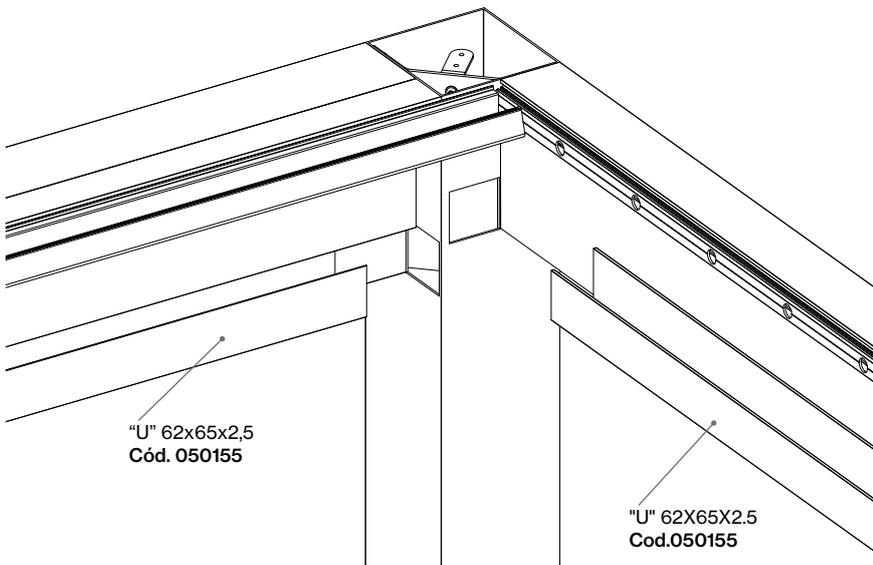
Installare i canali di scarico a "U" sulle travi **destra** e **sinistra**, inserendo l'estremità del canale attraverso il foro di scarico meccanizzato sulle colonne A e B e mettendolo allo stesso livello della trave e delle colonne C e D.
