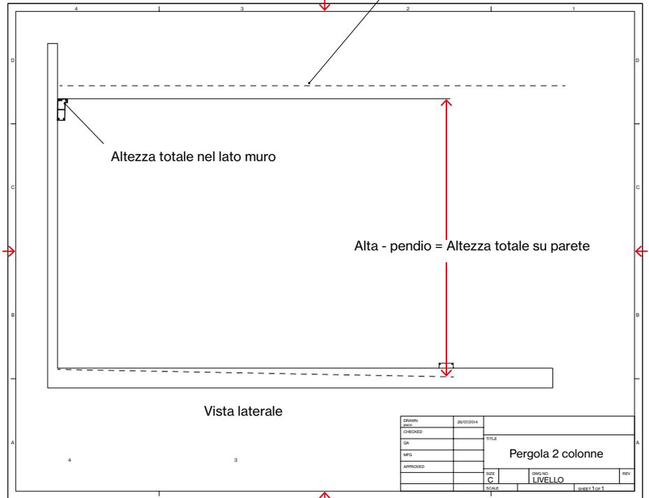
Posizionare le basi delle colonne secondo le misure del piano e del dislivello del suolo, tenendo in conto che queste devono formare un angolo di 90° rispetto al muro dove sarà installata la pergola.
